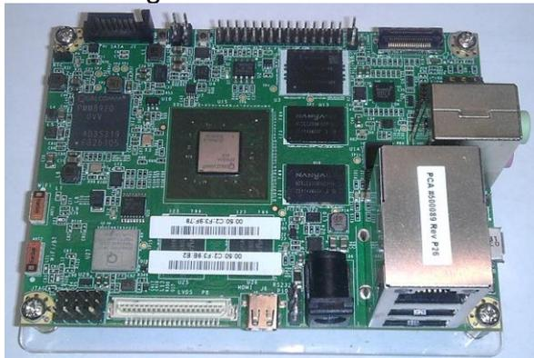
Fig. 5 IFC6410 - DragonBoard
